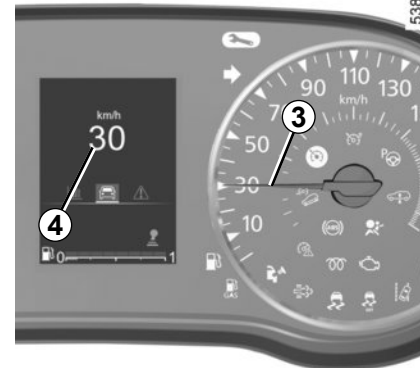
Fordulatszámérők 3 és a járműtől függően, 4 (km/h vagy mérföld/h)
